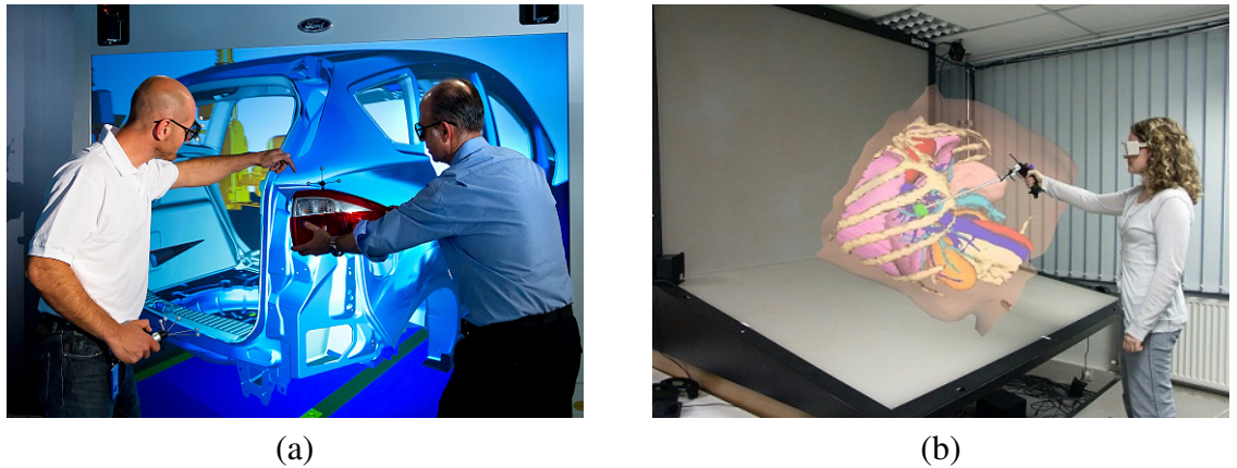
FIGURE 4.5 – Exemples de configurations visuelles semi-immersives : (a) mur et (b) plan de travail ou workbench.
